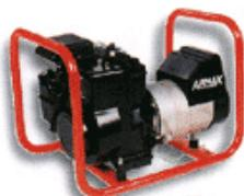
Macchina alimentata da un motore a scoppio destinata alla produzione di energia elettrica per l'alimentazione di attrezzature ed utensili del cantiere.
